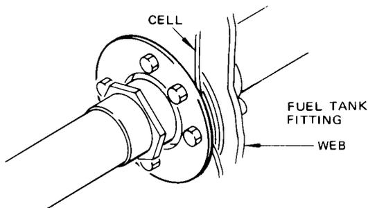
TYPICAL TUBE FITTING INSTALLATION
