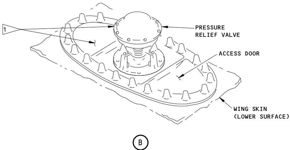
1 THE RESISTANCE FROM THE PRESSURE RELIEF VALVE TO THE ACCESS DOOR IS 0.01 OHM OR LESS.
