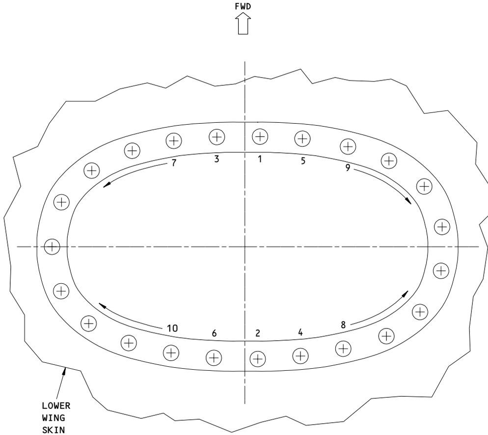
**NOTE:** TORQUE THE MOUNT BOLTS IN THE SEQUENCE SHOWN BY THE NUMBERS. THIS WILL MAKE SURE FUEL DOES NOT LEAK AROUND THE ACCESS PANEL.
