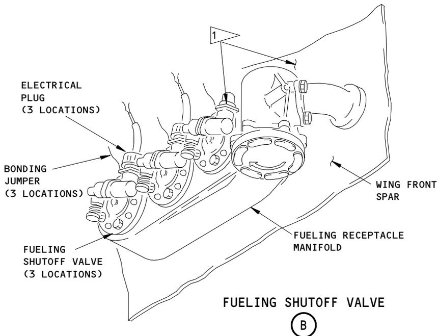
1 THE RESISTANCE FROM THE CONNECTOR FLANGE TO THE WING FRONT SPAR IS 0.001 OHM OR LESS.
