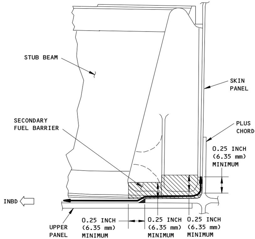
**STUB BEAM AT STA 639**
